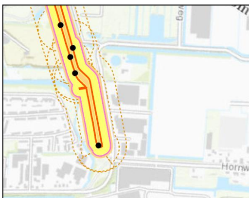
Figuur 9: beschermingszone waterkering
