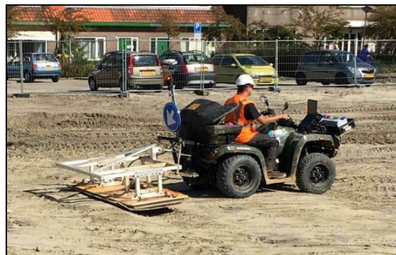
De 3D grondradar achter een quad
