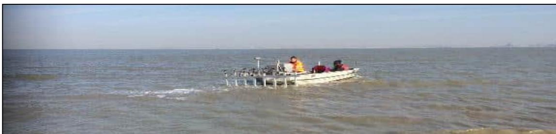
Uitvoeren passieve NON realtime waterbodemdetectie m.b.v. detectieboot.
