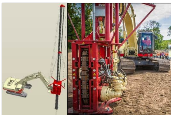
Uitvoeren dieptedetectie t.p.v. de landbodem
